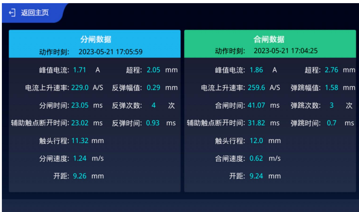
图 1-2： 断路器机械特性在线监测系统监测数据展示
