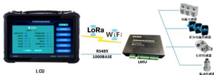
图 1-1： 断路器机械特性在线监测系统硬件组成
